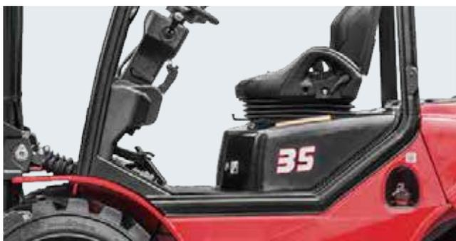
Il sistema di apertura rapido del cofano permette un facile accesso al motore
