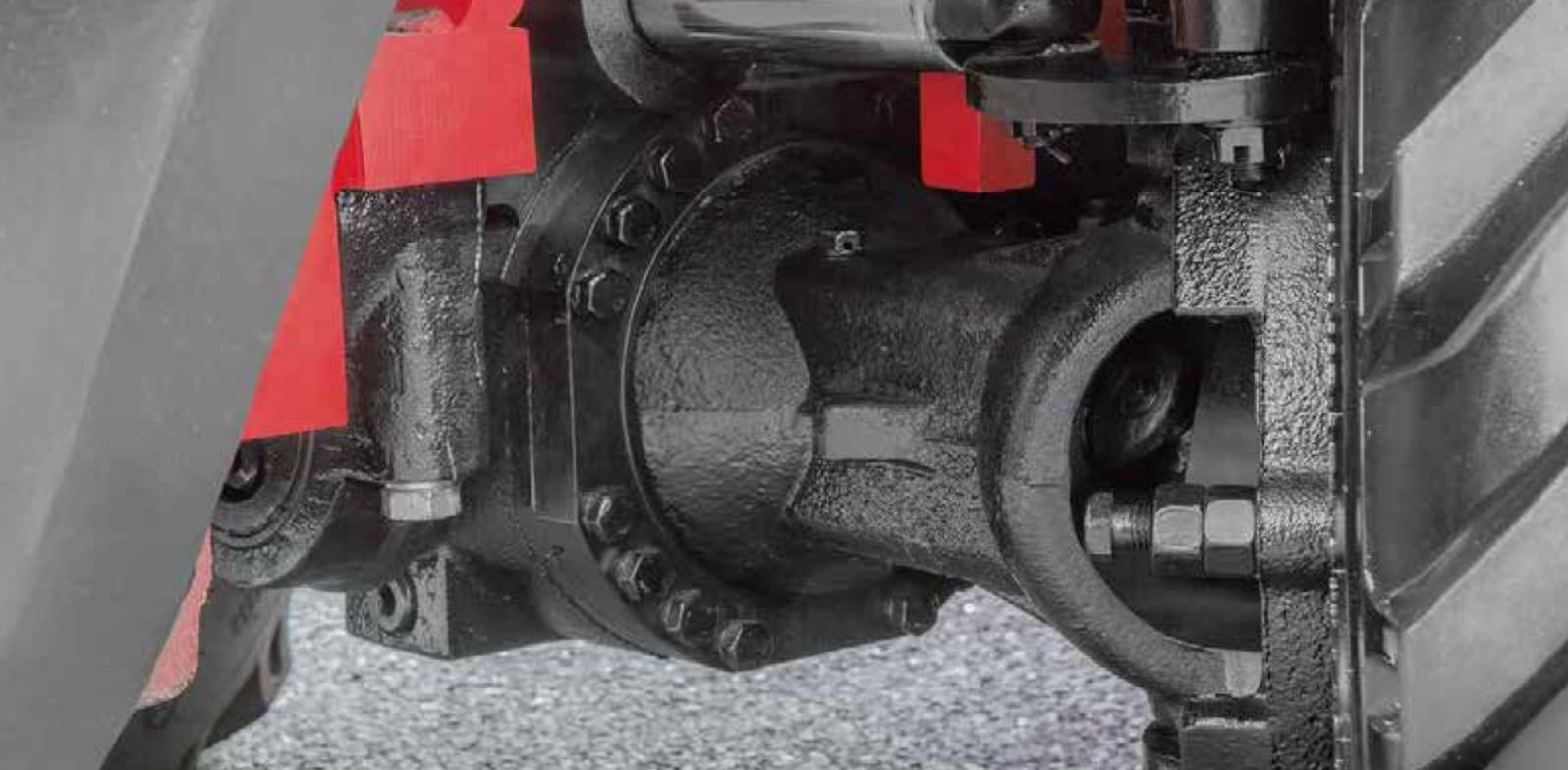
L'asse sterzante oscillante permette ad entrambe le ruote di scavalcare gli ostacoli mantenendo stabili il carrello e il carico.
