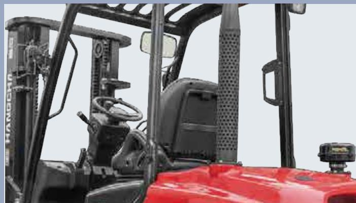
**4.** Il montante riprogettato fornisce un'ampia visibilità frontale grazie ad un maggiore distanza con il montante interno
