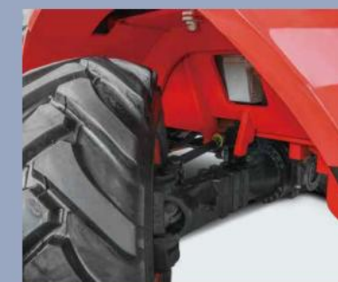
L'asse sterzante oscillante consente a entrambe le ruote di superare gli ostacoli mantenendo il camion e il carico in piano
