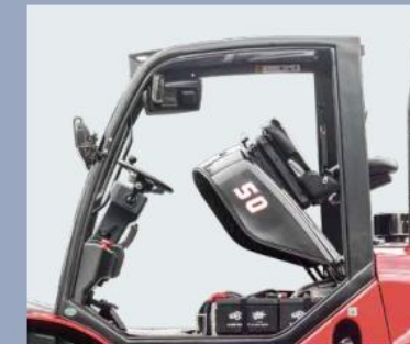
Il gancio di facile apertura consente un rapido accesso al vano motore
