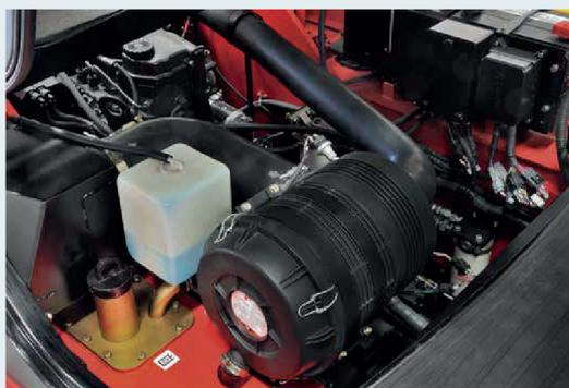
Il nuovo filtro dell'aria stampato con aspirazione tangenziale, doppia tenuta con filtro di sicurezza è durevole, esente da corrosione e resistente alle vibrazioni, offre una migliore efficienza del filtro e una minore resistenza all'aspirazione rispetto al precedente.
