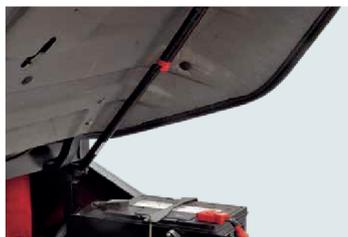
Il dispositivo di bloccaggio dell'ammortizzatore del cofano motore e il freno di stazionamento contribuiscono ad aumentare la sicurezza.
