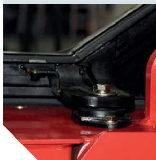
Sono stati applicati quattro livelli di assorbimento degli urti per ridurre le vibrazioni dalla strada al conducente. Il cuscinetto smorzante viene applicato per ridurre le vibrazioni, ad esempio tra l'asse sterzante e il telaio, il motore, il convertitore di coppia e il telaio, il tettuccio di protezione e il telaio. E il sedile ammortizzato è un'altra riduzione delle vibrazioni.
