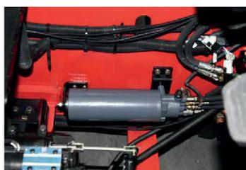
Nel sistema frenante è applicato un accumulatore di energia, il che significa che quando il motore è spento può anche fornire più di 4 volte il freno di emergenza.
