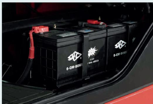
La batteria si trova sopra il serbatoio del carburante, tra di loro c'è un vano batteria e una piastra adiabatica per prolungare la vita operativa della batteria.
