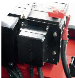
Tutti i controller, i relè e i fusibili di sicurezza sono allocati nella scatola del controller, liberi da acqua e polvere. I principali componenti elettronici sono impermeabili, il che rende l'operatore capace in ambienti difficili.
