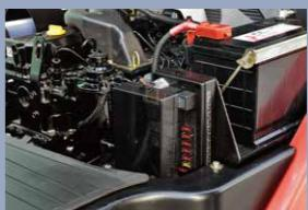
Il nuovo controller del veicolo integra tutti i componenti elettrici: componenti, presenta un'eccellente resistenza alla temperatura, all'acqua e alle vibrazioni per le operazioni più impegnative.
