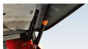
Il dispositivo di bloccaggio dell'ammortizzatore del cofano motore e il freno di stazionamento contribuiscono ad aumentare la sicurezza.
