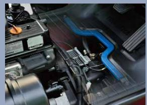
Oltre allo smorzatore in gomma tra il telaio e l'asse sterzante, l'ammortizzatore composito del motore e l'apparato propulsore completamente flottante garantiscono un collegamento flessibile tra il telaio e il sistema di guida, di conseguenza le vibrazioni di marcia e quelle provenienti dal sistema di guida vengono significativamente ridotte.
