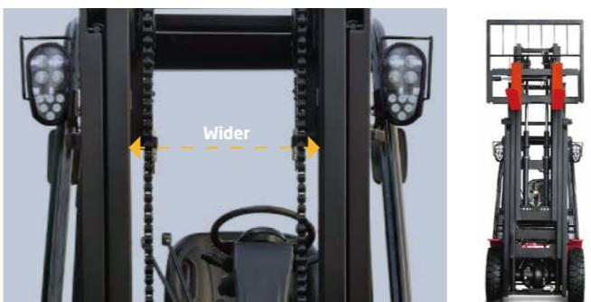
I cilindri di sollevamento anteriori sviluppati con diametro esterno più piccolo offrono all'operatore una visibilità anteriore superiore. I doppi cilindri di sollevamento garantiscono una migliore visibilità anteriore.
