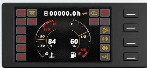
**Strumento interattivo:** lo strumento adotta un display LCD a colori da 4,0 pollici con quattro pulsanti interattivi e dispone di una funzione di comunicazione bus CAN. Il protocollo di comunicazione è compatibile con gli standard CANopen e SAE J1939.
