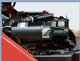
Il nuovo filtro dell'aria stampato è durevole, esente da corrosione e resistente alle vibrazioni, offre una migliore efficienza del filtro e una minore resistenza all'aspirazione rispetto al precedente.
