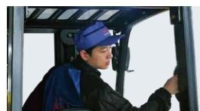
Una presa opzionale di assistenza sul montante posteriore con pulsante del clacson migliora la sicurezza dell'operatore durante la guida in retromarcia.
