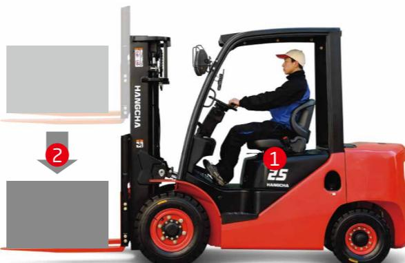
Il sistema di rilevamento della presenza dell'operatore incorpora la funzione di sollevamento/inclinazione e blocco dello spostamento. Quando l'operatore lascia il sedile, il sistema blocca automaticamente il sollevamento/inclinazione e disabilita la traslazione per garantire la sicurezza. È adottato un dispositivo di strozzamento per evitare che l'albero vada fuori controllo anche se alcuni tubi sono rotti.
