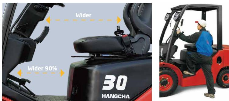
Lo spazio aggiuntivo per i piedi è previsto per ridurre significativamente l'affaticamento dell'operatore. Il nuovo gradino ampio e antiscivolo rende l'entrata e l'uscita facile e sicura. Il sistema di controllo proporzionale elettroidraulico opzionale contribuisce a una movimentazione del carico più sensibile e precisa. Le leve facili da azionare garantiscono un'operazione di movimentazione del carico totale. Viene fornito un bracciolo per ridurre l'affaticamento.
