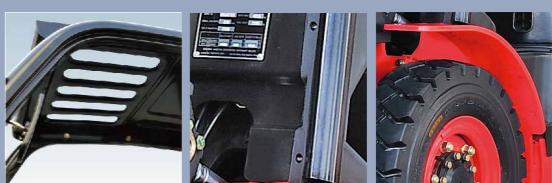
La serie XF è caratterizzata da un design robusto, telaio e cofano motore stampati, pannello strumenti e protezione della testa stampati, montante con binario a profilo pesante si combinano per fornire un'eccellente rigidità, che garantisce un'affidabilità eccezionale anche nei lavori pesanti.
