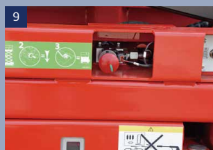
Valvola di abbassamento manuale: quando il sistema operativo si guasta o la carica della batteria è troppo bassa per consentire il declino della piattaforma, possiamo utilizzare questa valvola per abbassare la macchina
