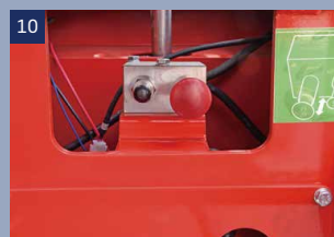
Valvola di rilascio manuale: quando la macchina non può muoversi, è possibile spingere la macchina dopo aver premuto questa valvola
