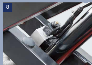
Valvola antideflagrante: per evitare che la macchina cada quando il tubo dell'olio perde
