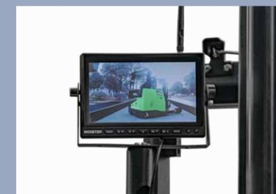
Sistemi di telecamere per la guida e la movimentazione dei pallet
