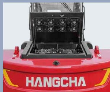
Il sistema di raffreddamento con ventola integrata garantisce la stabilità dell'impianto elettrico ed il cofano completamente apribile rende la manutenzione più comoda
