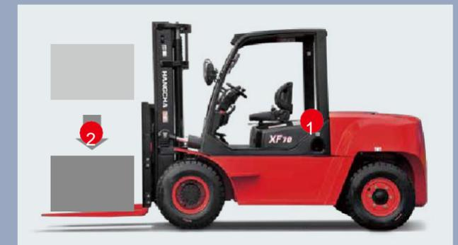
1. Il sistema di sensori del sedile incorpora la funzione di sollevamento/inclinazione e di blocco della corsa. Quando l'operatore lascia il sedile, il sistema blocca automaticamente il sollevamento/inclinazione e disattiva la marcia per garantire la sicurezza.
