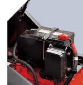
Tutti i controlli, i relè e i fusibili di sicurezza sono collocati nella scatola del controllo, al riparo da acqua e polvere. I principali componenti elettronici sono impermeabili, in grado di operare in condizioni ambientali difficili. Inoltre, il carrello è dotato di un filtro aria di marca famosa.
