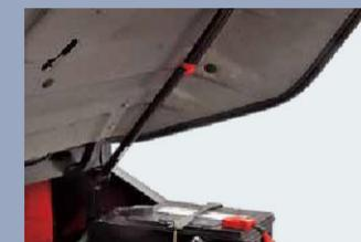
Il dispositivo di blocco dell'ammortizzatore del cofano motore e il freno di parcheggio contribuiscono ad aumentare la sicurezza.
