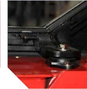
Sono stati applicati quattro livelli di ammortizzazione per ridurre la trasmissione delle vibrazioni dalla strada al conducente. L'elemento di ammortizzazione viene applicato per ridurre le vibrazioni, ad esempio tra l'assale sterzante e il telaio, il motore, il convertitore di coppia e il telaio, il tettuccio di protezione e il telaio. Il sedile sospeso riduce ulteriormente le vibrazioni.
